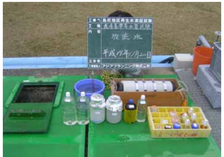
下水放流水を利用した再生水の水質試験
